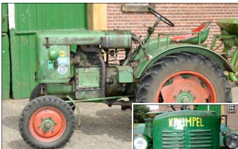
Insgesamt hat Joseph Krümpel vor und nach dem 2. Weltkrieg nur etwa 80 Schlepper gebaut. Ab Ende der 40er-/Anfang der 50er-Jahre hatte der Deutz F2M 414 25 PS und der Kühler erhielt eine abgerundete Blechverkleidung.
