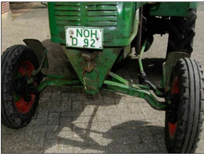
Die gegenüber dem 22er- veränderte Vorderachse des 25er-Krümpel.
